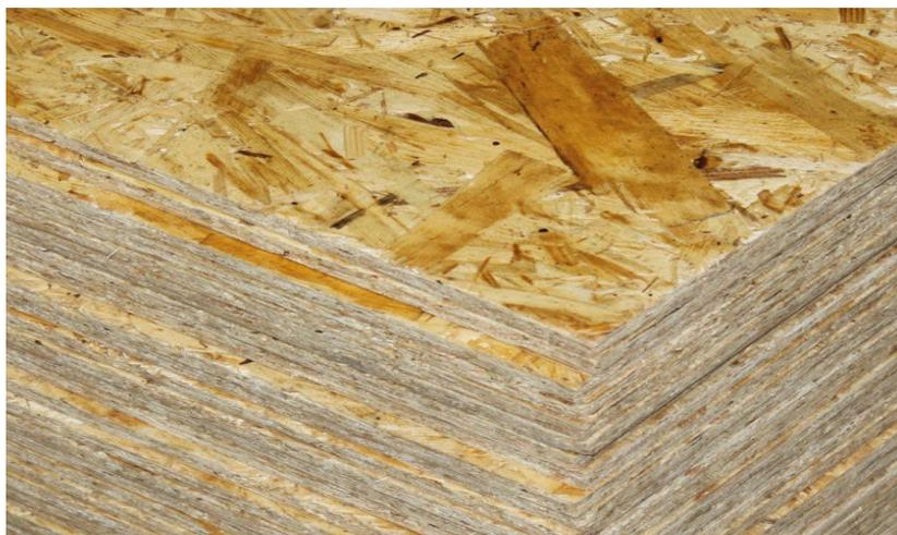
O OSB 3 é um painel de elevado desempenho fabricado a partir de camadas de aparas de madeira cruzadas a 90° e aglutinadas através de colas resistentes à humidade, tornando-o indicado para utilizações em ambientes húmidos. Pode ser utilizado em variadíssimas situações, sobretudo como base de suporte de coberturas isolamentos e materiais
